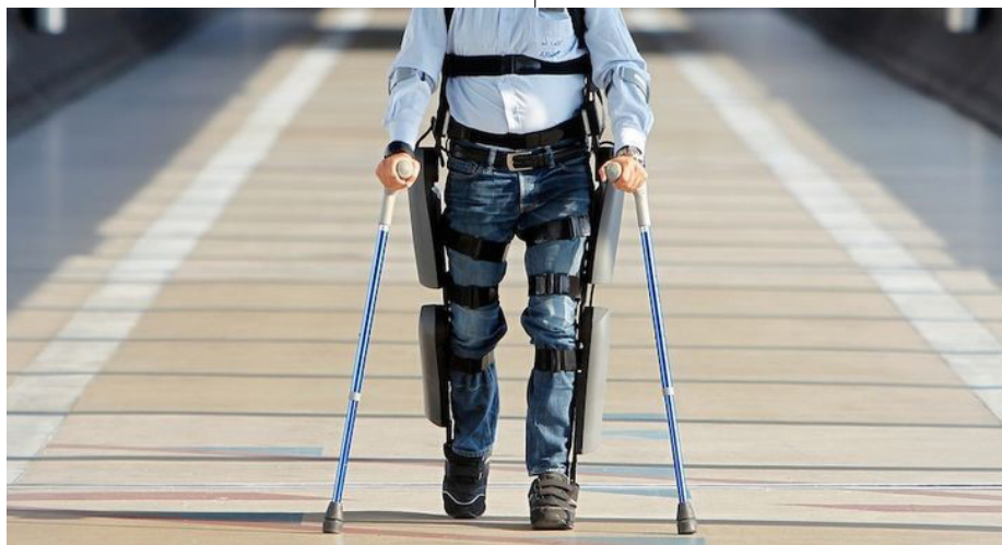
L'exosquelette Rewalk permet aux paraplégiques de se déplacer sans fauteuil roulant © Rewalk Robotics
