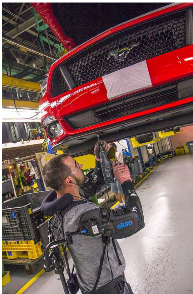
Ford équipe certains ouvriers spécialisés dans l'assemblage de pièces automobiles de vestes exosquelettes proposés par la société Esko afin de les soulager © Esko
